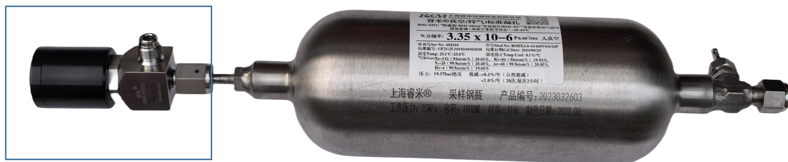
RMI-PSOZV™ 标准漏孔, RMI-PSOZV常闭气动阀 组份: 94%atom Xe-132, 56atom% Kr-56, Ar, N 2 , He各20% N 2 分漏率: 3.35 \times 10^{-6}\text{pa}\cdot\text{m}^3/\text{sec} 漏率年衰减: < 1% (20次x2小时)
