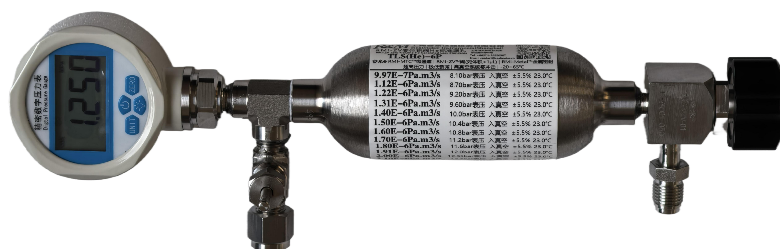
RMI-MDZV™ 标准H 2 漏孔, 160cc, RMI-MDZV手动阀 He漏率 1.60\text{E}-6\text{pa}\cdot\text{m}^3/\text{s}@10.8\text{bar} , 多个压力校准点 漏率年衰减: < 2.5% (年使用60次x60分钟, 平时务必关闭阀门)
