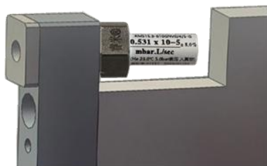
OK件，推荐漏率 \approx 工件阈值Q0/2
