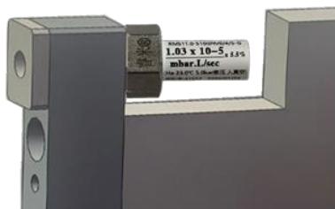
Q0件：标定，漏率按照 工件阈值Q0 \pm 10%加工
