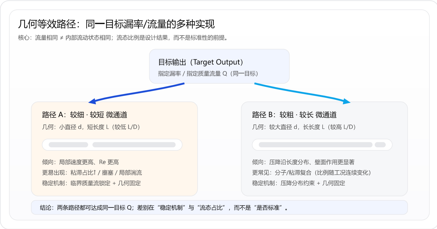
图 2 | 几何等效路径图：同一目标漏率/流量可由不同（d, L）组合实现；在相同目标下，细短与粗长的内部流态占比不同，但都可形成稳定、可复现、可标定的标准漏孔。
