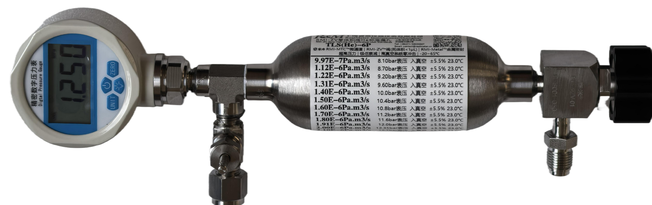
RMI-MDZV™H 2 漏孔, 160cc, MDZV™ 阀 H 2 漏率1.60E-6pa.m 3 /s@10.8bar, 多个压力校准点 漏率年衰减: <2.5%( 年使用60次x60分钟,平时务必关闭阀门)
