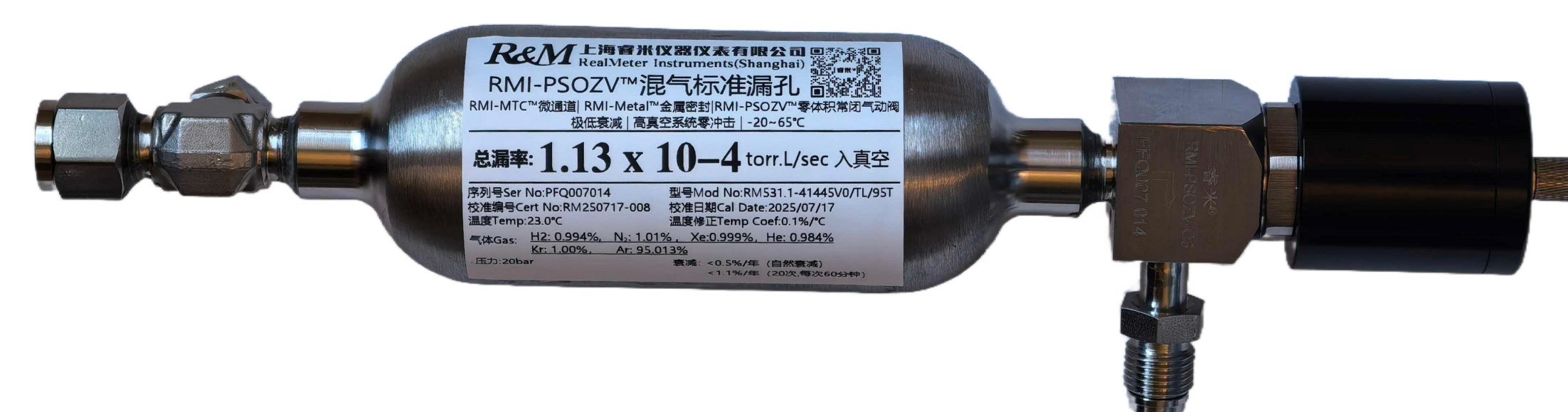
RMI-PSOZV™混气漏孔, PSOZV™ 阀 组份: H 2 , He, N 2 , Kr, Xe各1%, 余Ar (95%) 总漏率: 1.13x10 -4 Torr.L/sec 漏率年衰减: <1.1%( 20次x2小时)
