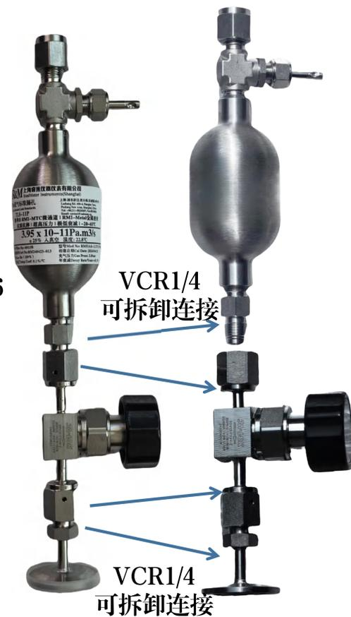
目前仅有极少数厂家能制作高精度标准漏孔 (-11, -12, -13pa.m<sup>3</sup>/sec), 但都采用渗透膜工艺 (如石英, 或金刚石等), 因为密封工艺存在自身泄漏 (1x10<sup>-10</sup>atm.cc/sec) 导致漏率稳定性差, 同时温度变化对漏率的影响大 (温度系数4.0%/°C) 漏率不稳定。
