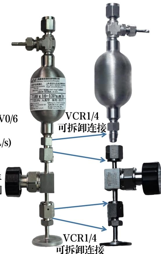
目前仅有极少数厂家能制作高精度标准漏孔 (-11, -12, -13pa.m<sup>3</sup>/sec), 但都采用渗透膜工艺 (如石英, 或金刚石等), 因为密封工艺存在自身泄漏 (1x10<sup>-10</sup>atm.cc/sec) 导致漏率稳定性差, 同时温度变化对漏率的影响大 (温度系数4.0%/°C) 漏率不稳定。
