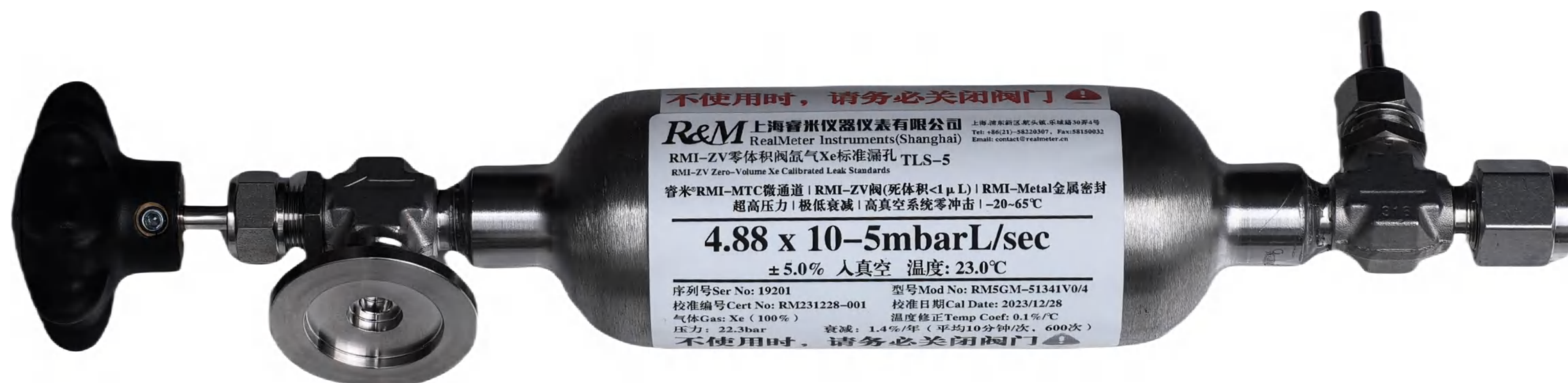
实物照片: 氙气Xe标准漏孔, 4.88x10 -5 mbar.L/sec, KF25, , RMI-MZV阀
