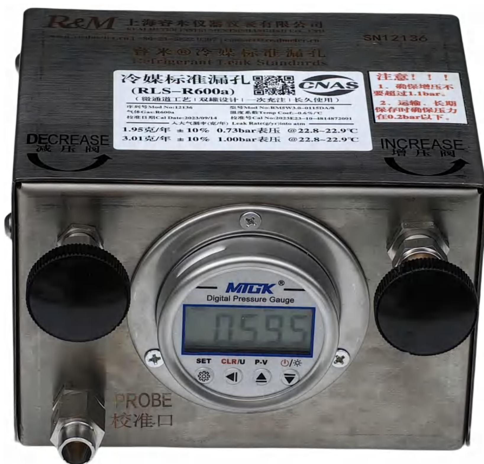
R600a冷媒漏孔 2, 3克/年
