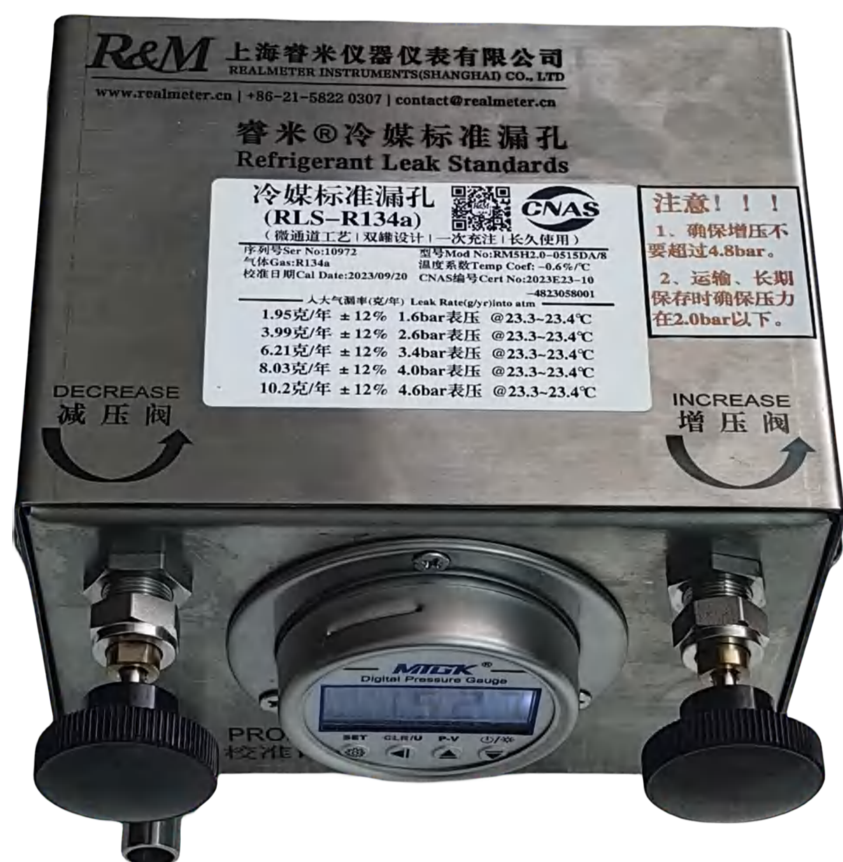
R134a冷媒漏孔 2, 4, 6, 8, 10克/年
