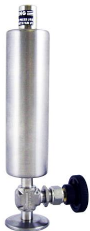
INFICON/Leybold 内置漏孔
