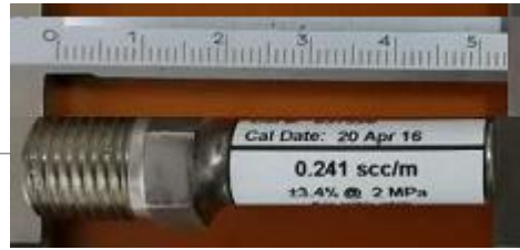
0.241sccm@2Mpa, 1/8NPT外螺纹
